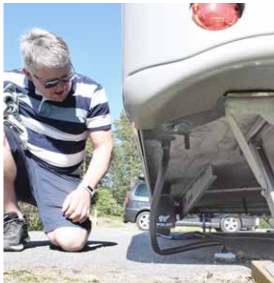
Spillvattentanken töms via slang i avloppet. Vattenlåset är en golvbrunn för anslutning av handfat.
