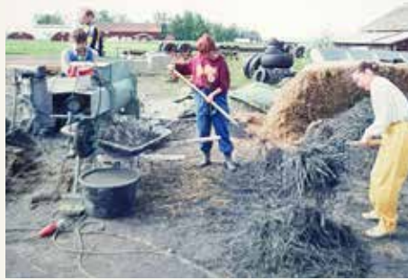
Test av olika proportioner i lerhalmblandningen.
